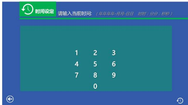
主菜单选择“修改时间”功能，进入时间修改页面。根据上方的格式，输入当前的时间，按右下键时间修改按钮，则修改完毕。按“←”箭头，取消修改，保留原时间不变。
