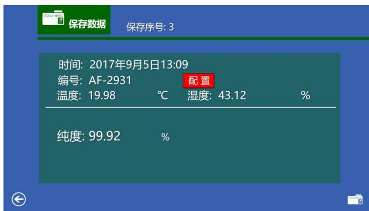
按红色“配置”按钮可以输入测试编号，确认无误后可以按右下角的“保存数据”，将当前数据保存到仪器内部。仪器最多可以保存 1000 条数据。
